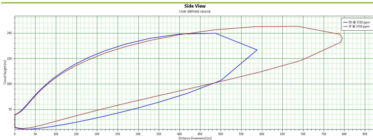
Figure 10 : Représentation graphique de la dispersion atmosphérique des fumées engendrant une visibilité de 2 m
