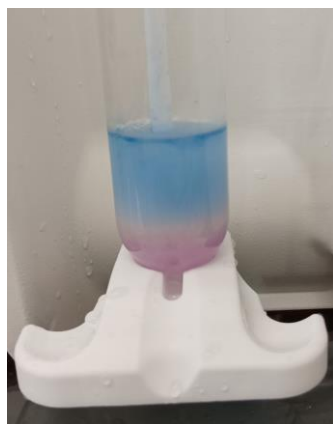
Analyse d'ammonium par colorimétrie
