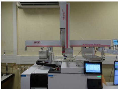
Injecteur large volume pour l'analyse de produits inconnus
