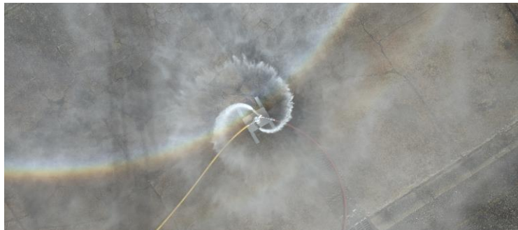
Mesure de la vitesse de rotation de la buse du jet rotatif
