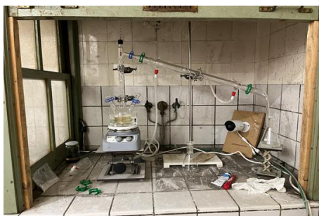
Purification du toxique de guerre par hydrodistillation
