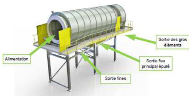
Trommel, extrait de la Description des installations, dossier d'autorisation d'exploiter
