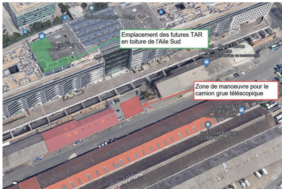
EMPLACEMENT POUR LA GRUE DE LEVAGE DES TAR. 65 RUE BARON LE ROY
